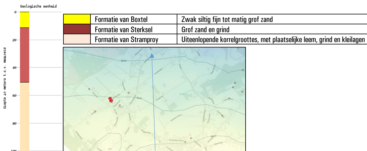
Figuur A: opbouw ondergrond.
