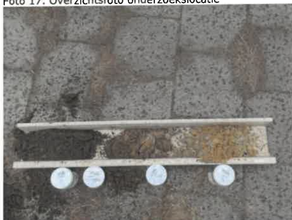
Foto 19. Profiel boring N06
