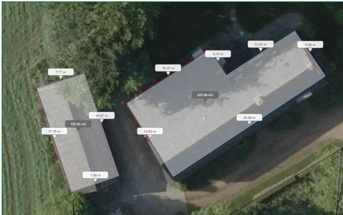
Afbeelding 33. Oppervlakte bestaande bebouwing woonboerderij en veldschuur/ werktuigenberging
