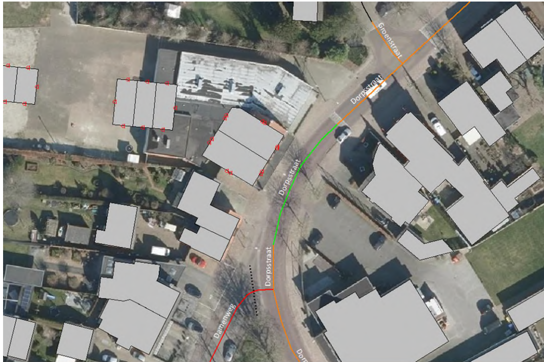
Figuur 4.1: Schematische weergave van de ligging van de bronmaatregel op de Dorpsstraat (groen = stille elementenverharding, oranje = elementenverharding in keperverband, rood = SMA 0/8).
