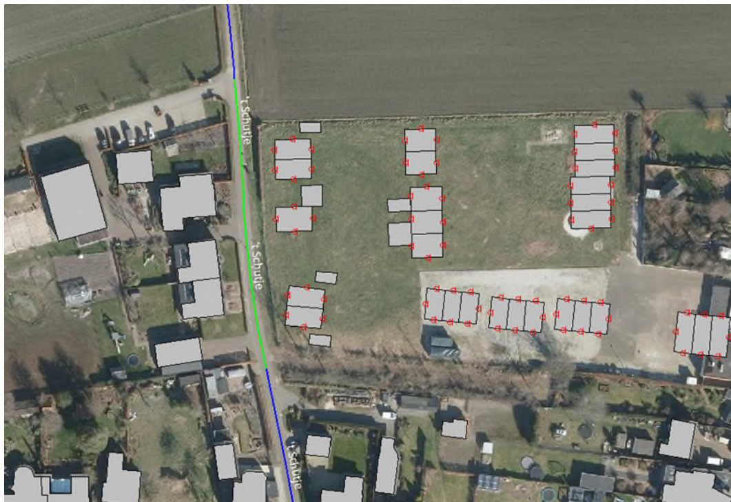
Figuur 4.2: Schematische weergave van de ligging van bronmaatregel op 't Schutje (groen = stille elementenverharding; blauw = elementenverharding niet in keperverband).
