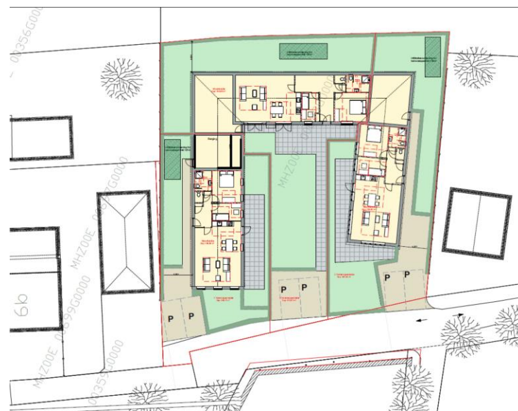
Figuur : indeling terrein met locatie infiltratievoorzieningen
