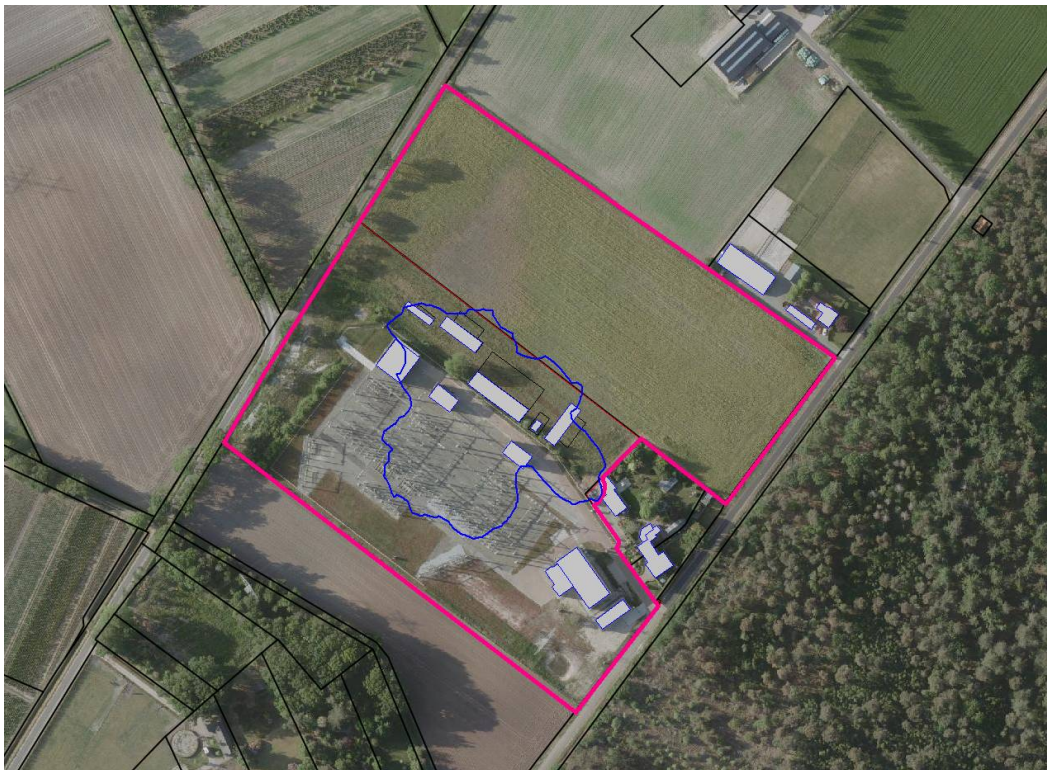
f5.1 Voorstel zonegrens (roze lijn) excl. toeslag K, en omhullende 50 dB(A) etmaalwaardecontour (blauwe lijn)
