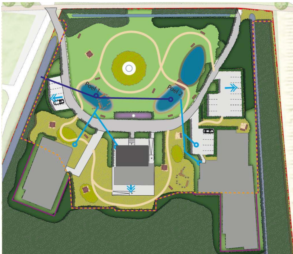
Figuur 12: Schematische weergave van de regenwaterafvoer. Bron: Orbis, april 2024.
