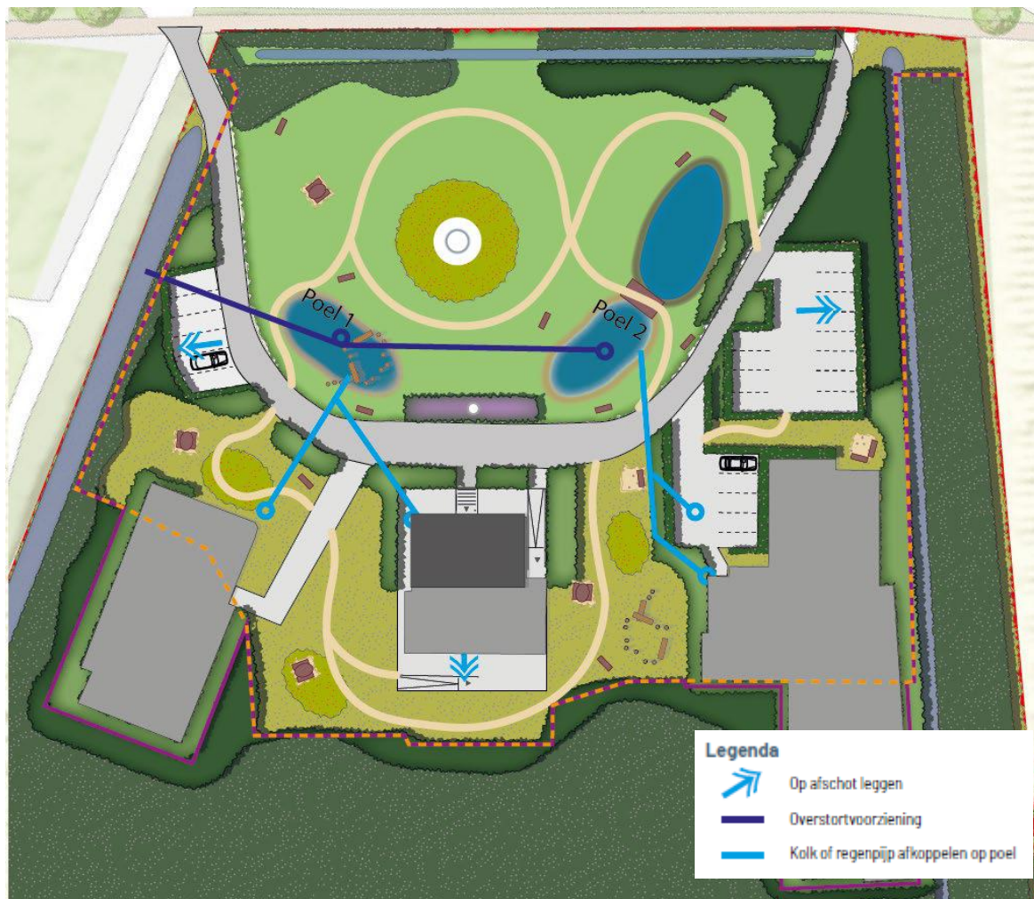
Afbeelding 22 : Schematische weergave van de regenwaterafvoer.
