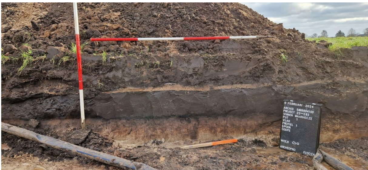
Figuur 16: Proefsleuf 1, profiel 1-1. Onder de laag humusrijk zand is het moerige laagje te zien dat waarschijnlijk een restant vormt van veenvorming
