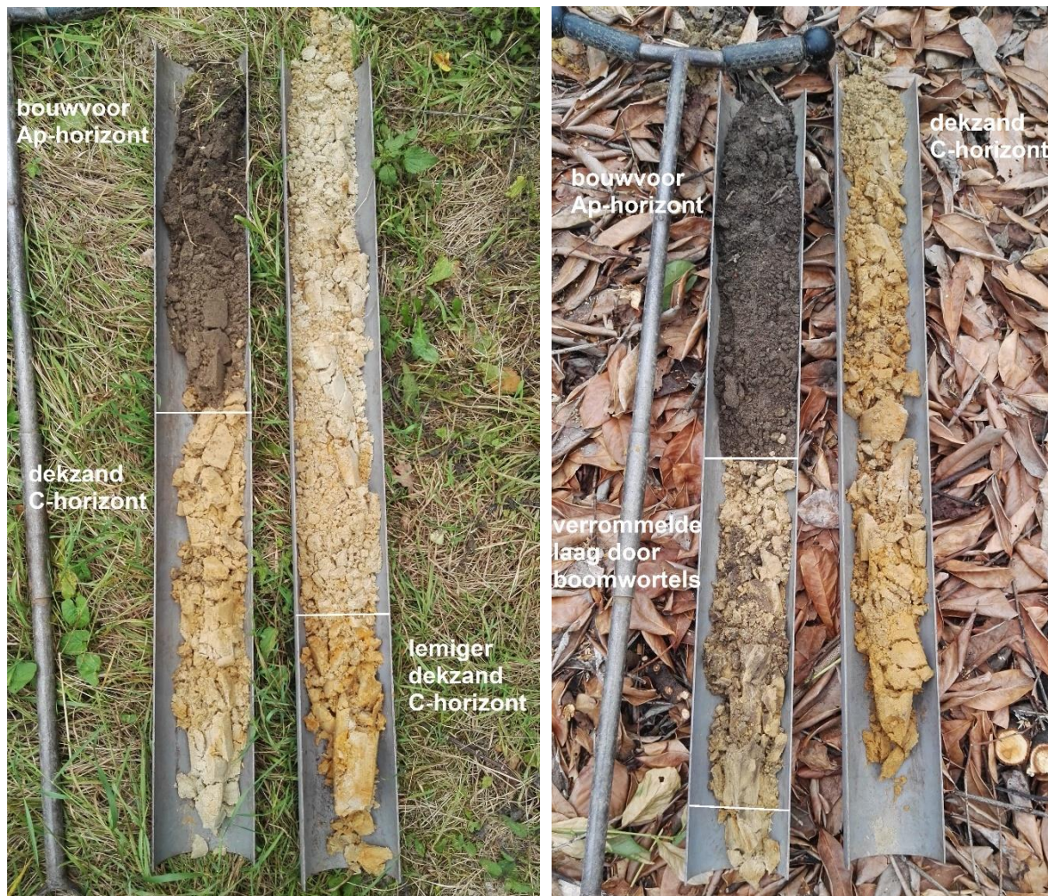
Figuur 10: Het opgeboorde sediment van boring 2 (links) en boring 4 (rechts).
