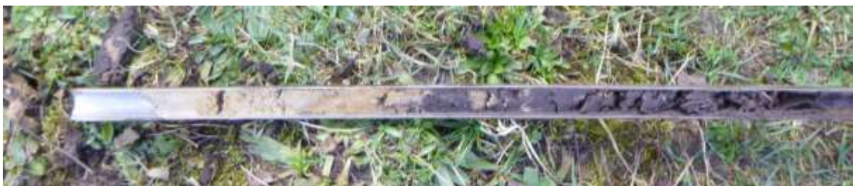
Figuur 19: Foto van de kenmerkende bodemopbouw op het vermoedelijk afgegraven deel van het plangebied met een humusrijke toplaag die direct op door oxidatievlekken gekenmerkt, geelgrijs en lemig dekzand ligt.
