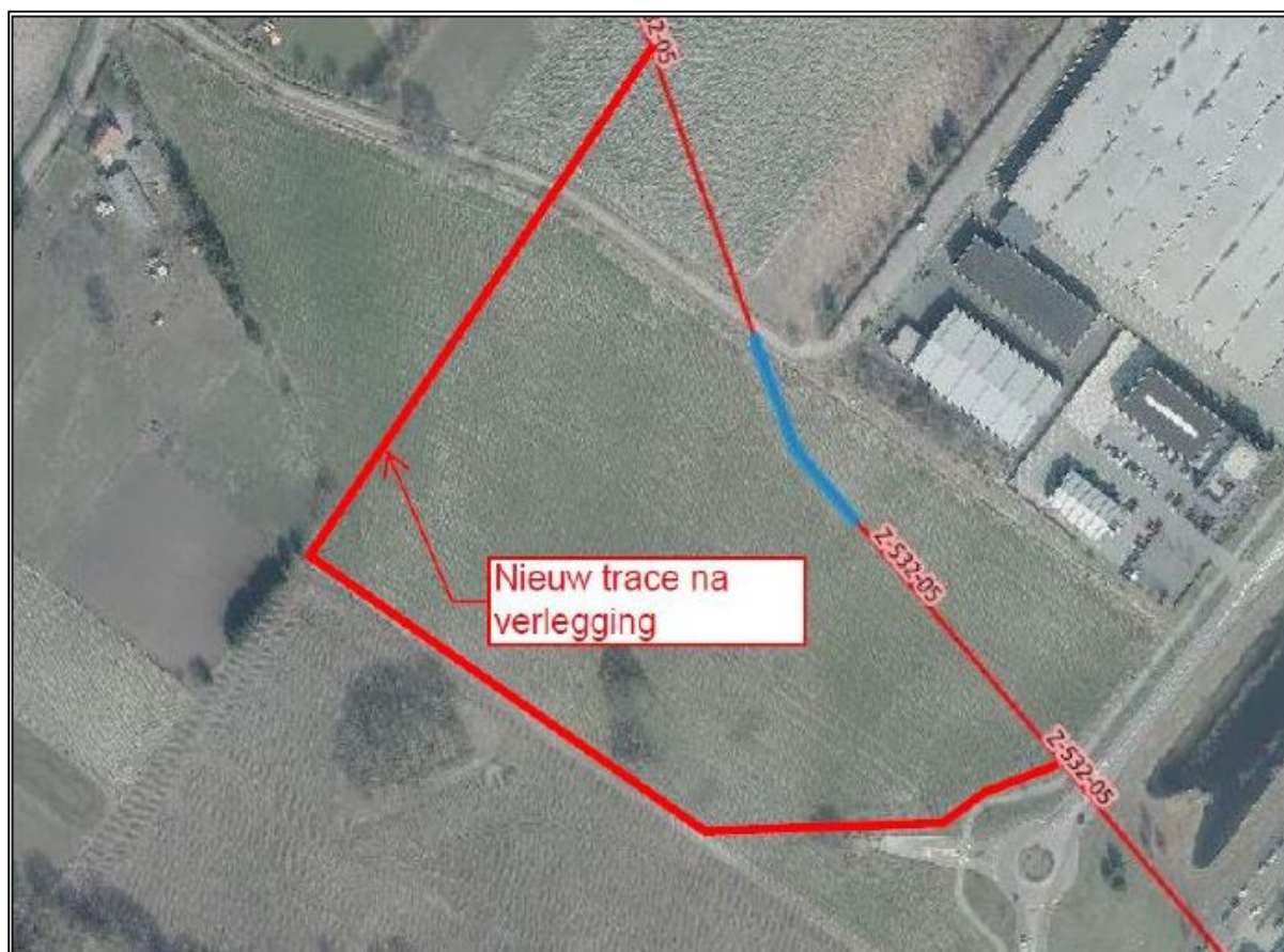
Figuur 9. Nieuwe situatie na verleggen gasleiding.
