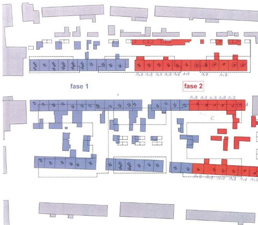
Figuur 5.4 Het plangebied. De te slopen woningen zijn blauw aangegeven, de woningen waar de nestkasten zijn opgehangen zijn rood aangegeven. De vleermuiskoloniekast C is direct onder de dakgoot, aan de buitengevel van woning 7 gehangen.
