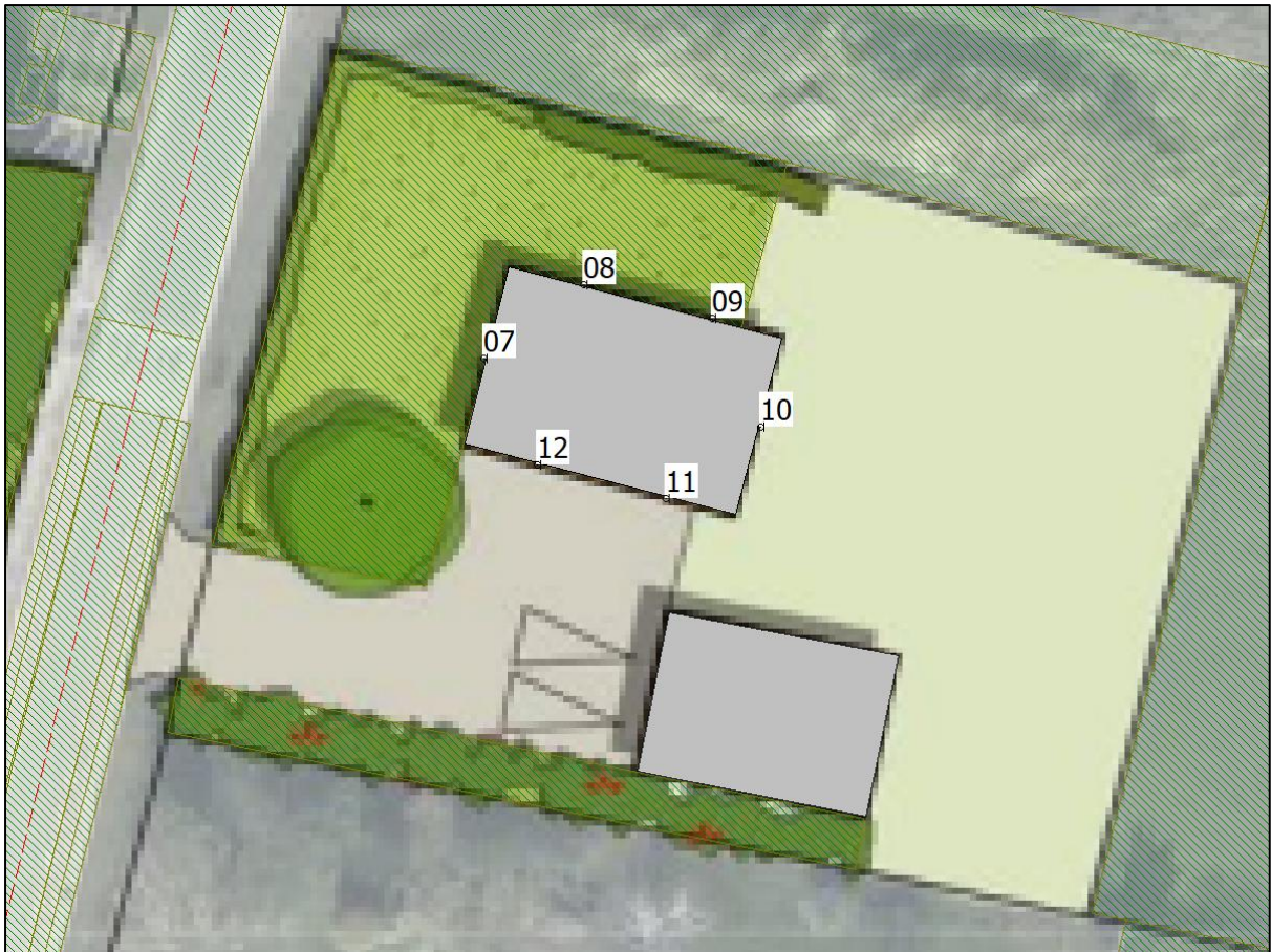
Toetspunten op de gevels van de woning aan de overzijde van de weg (Bron Geomilieu, zie ook bijlage 1)
