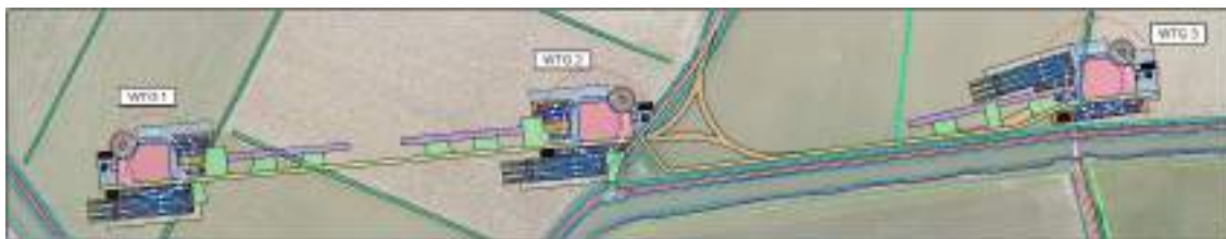
Figuur 4.2 Illustratie positionering windturbines, ontsluitingsweg en opstelplaatsen
