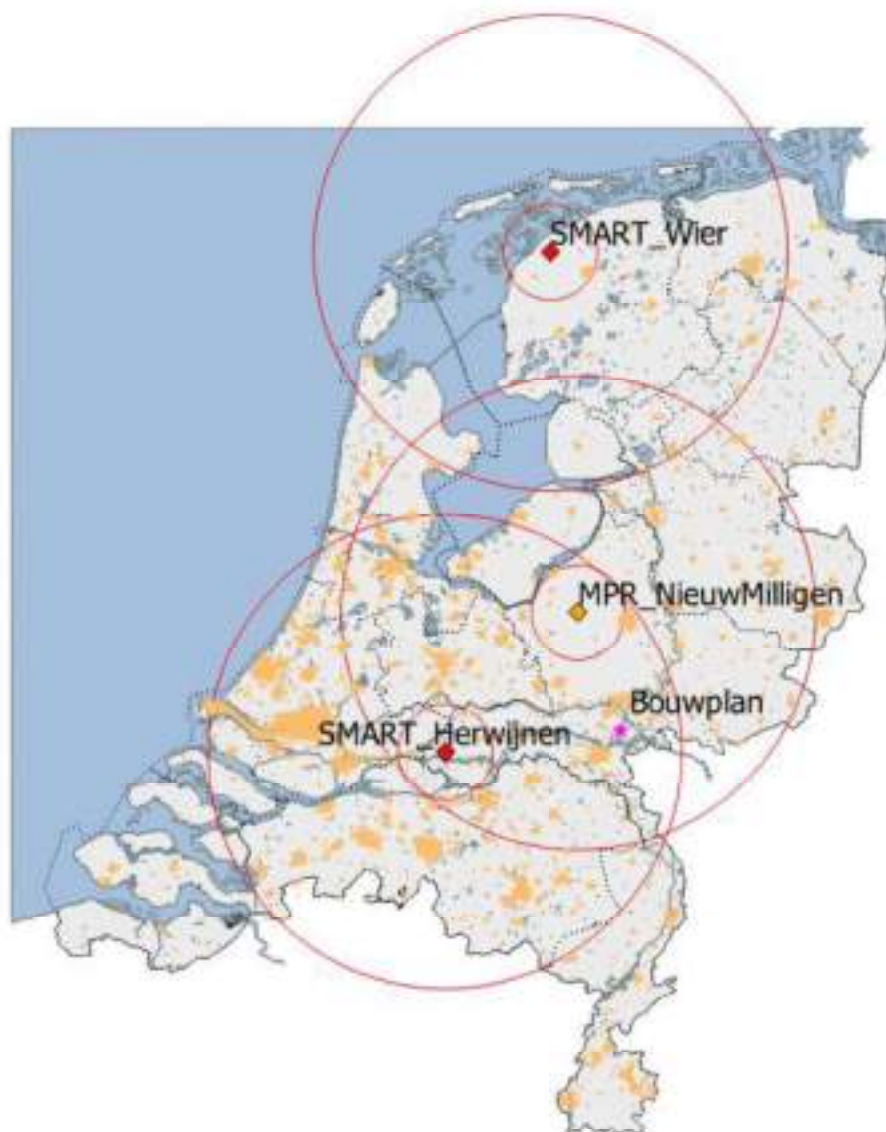
Figuur 4 Locaties van de nieuwe SMART-L EWC GB gevechtsleidingsradars (rode ruit) en de bestaande MPR (oranje ruit) met daaromheen de 15 en 75 km cirkels. De oranje vlakken zijn de in de AHN-1 gedefinieerde stedelijke gebieden. De ligging van het te toetsen bouwplan is aangegeven met een roze ster.
