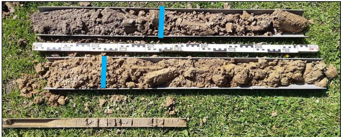
Afbeelding 13: Foto van het boorprofiel van Boring 1 met van boven naar onder en v.l.n.r. achtereenvolgens de bouwvoor, de overslagafzettingen en de afwisseling van oeverafzettingen en komklei
