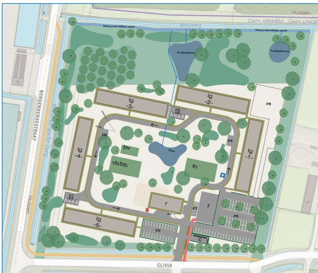
Figuur 54. Principetekening ligging van de afvoerleiding/landbouwkundige afvoerleiding. Bron: Looije Agro Technics BV.
