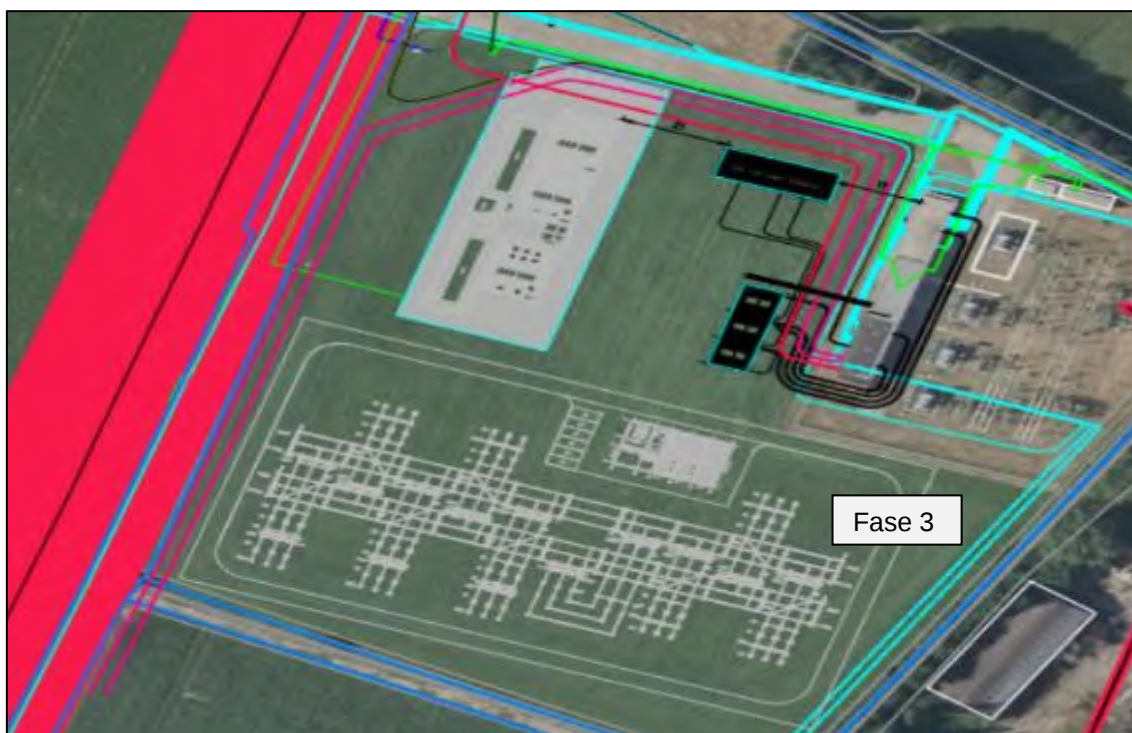
Figuur 5: Technische schets van het volledige planvoornemen (fase 1, 2 en 3). Fase 3 betreft de toekomstige (2040) schakeltuin. Tot die tijd is de grond in gebruik voor extensieve landbouw en begrazing door schapen.
