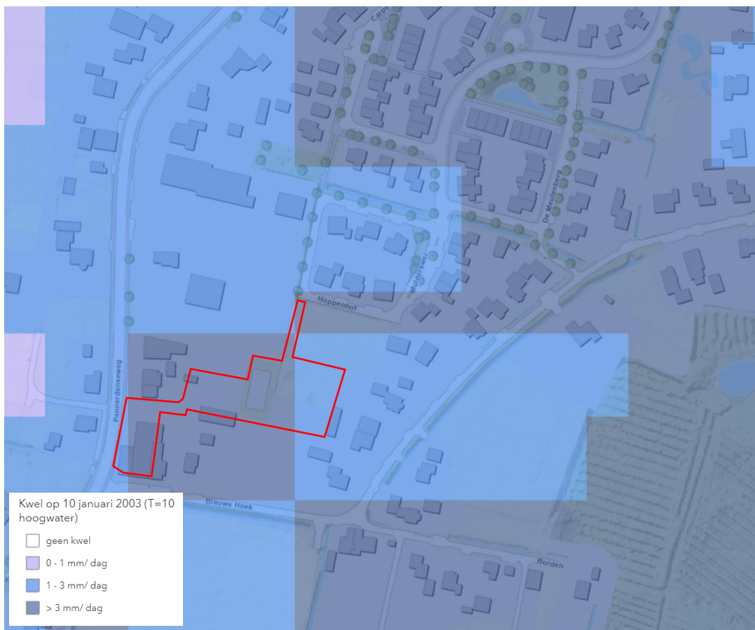
Figuur 3.9 Kwel/wegzijing Moria 10 januari 2003; T=10 hoogwater (bron: Klimaatatlas waterschap Rivierenland)
