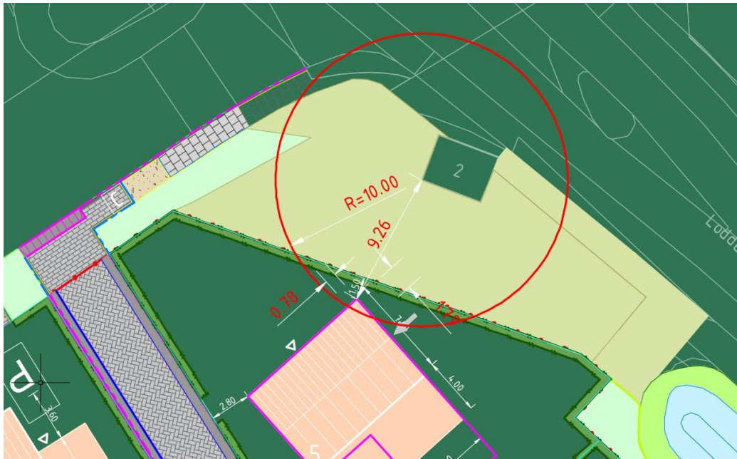
Kortste afstand beoogde woningen tot transformatorhuisje
