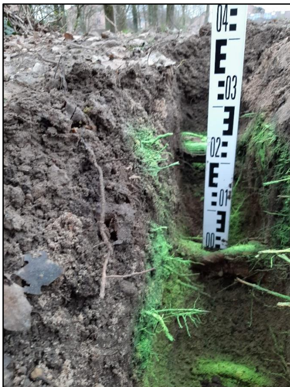
Figuur 19. Diepte aangetroffen gestelwortels (30 en 40 cm - maaiveld) met essentiële transportfunctie
