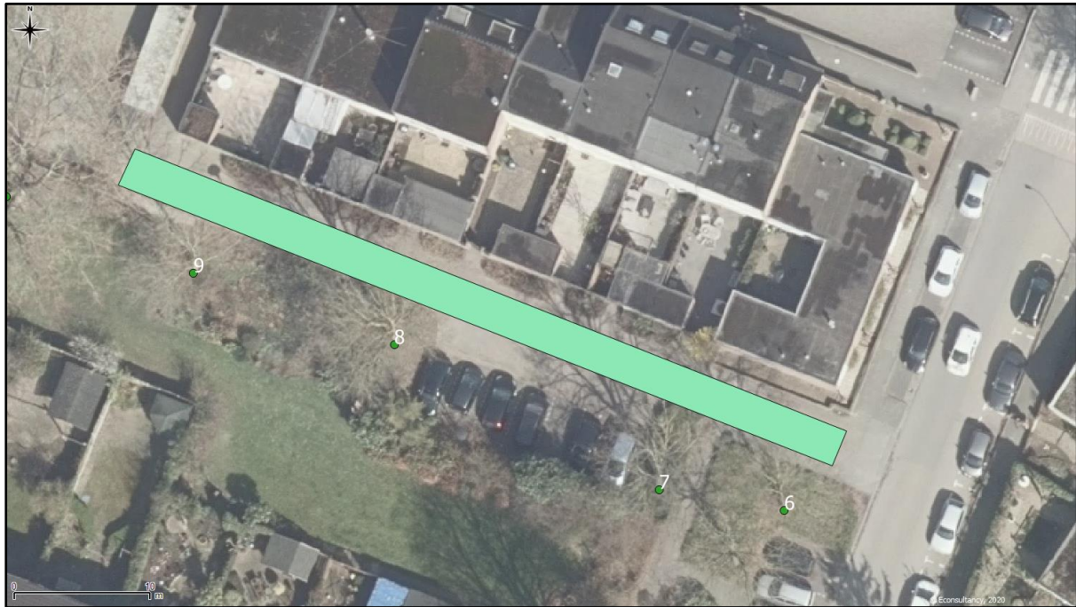
Figuur 16. Geplande positionering asfaltverharding ten opzichte van boom 6, 7, 8 en 9.
