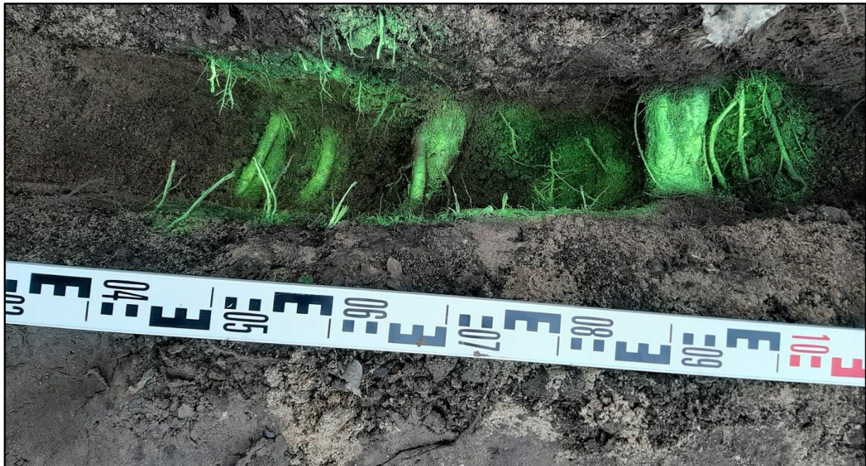
Figuur 18. Overzicht proefsleuf nabij boom 10. Intensieve en evenredig verspreide beworteling aanwezig.
