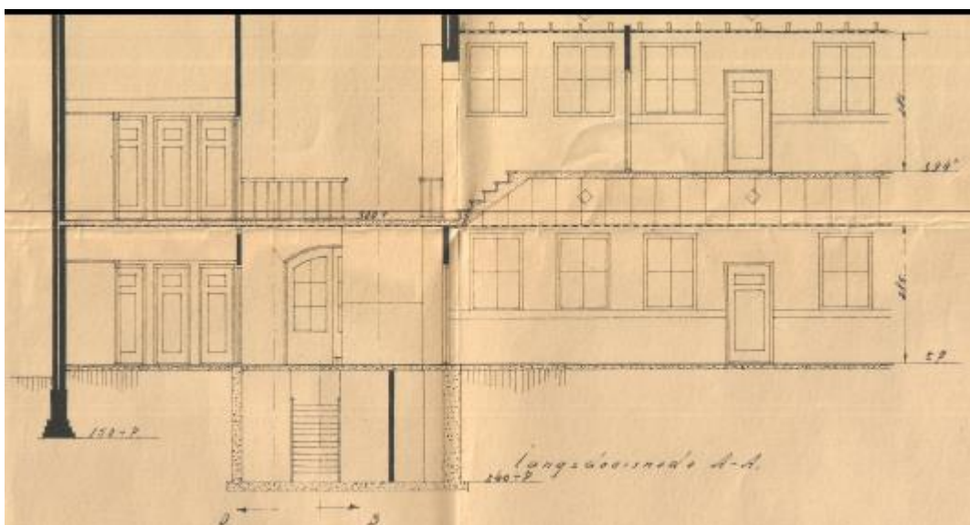
Figuur 15. Dwarsdoorsnede van de jongensschool en de kelder, gezien vanaf de Conventstraat. Het getrapte zwarte deel links, met 150 -P, geeft één van de funderingen weer.
