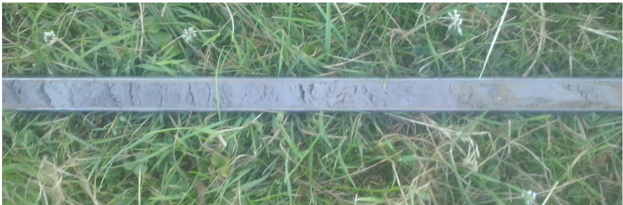
Figuur 17: Het door zandlaagjes onderbroken kleipakket zoals dit in de boringen 1 tot en met 5 en 7 is aangetroffen
