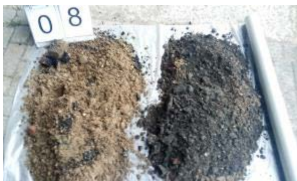
Foto 11: Fundatielaag (grindhoudend zand op grind, baksteen en asfalt houdende klei) gat 08.
