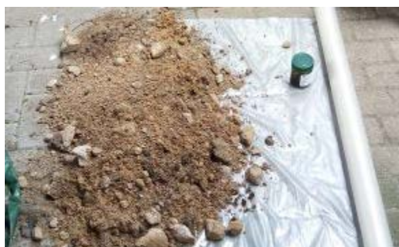
Foto 12: Fundatielaag (grind/ zandcement) gat 12.
