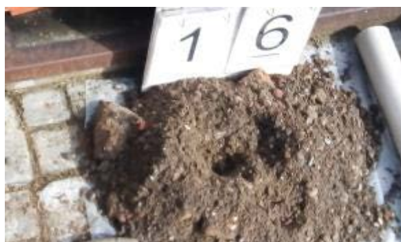
Foto 14: Fundatielaag (puinhoudend zand) gat 16.
