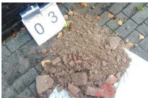
Foto 9: Fundatielaag (puinhoudend zand) gat 03.
