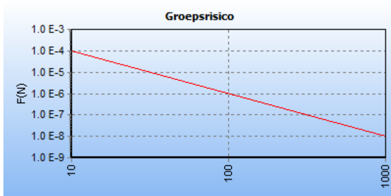
5.13 Figuur 5.13 FN curve voor 4630_leiding-N-578-23-deel-1 van N.V. Nederlandse Gasunie voor de kilometer tussen stationing 0.00 en stationing 940.00
