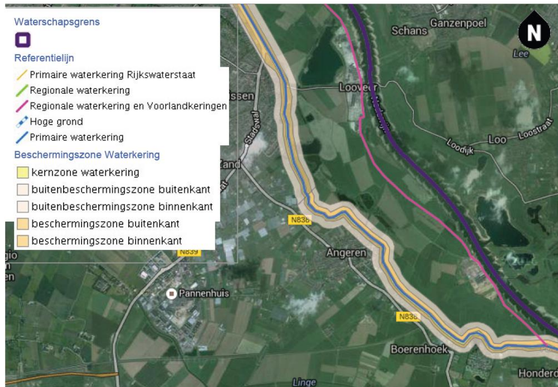
Figuur 4-3 Waterkering Rijndijk met bijbehorende beschermingszones
