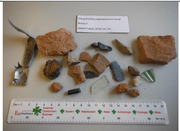
Boring 4 (20-65 cm): resten/brokken puin en baksteen, fragmenten leisteen, fragmenten glas en een stuk roestvrij staal, (sub)recent (19 e /20 e eeuw)
