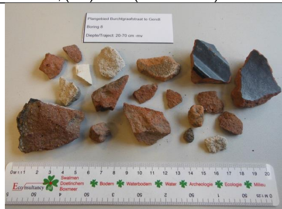
Boring 8 (20-70 cm): resten/brokken puin en baksteen, fragmenten dakpan en een fragment industrieel aardewerk, (sub)recent (19 e /20 e eeuw)
