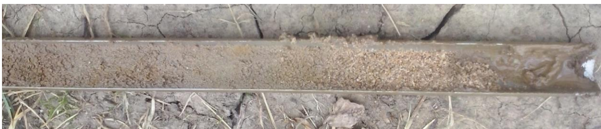
Figuur 14: Foto van het uiterst grove, grindhoudende zand dat onderin alle boringen is aangetroffen.
