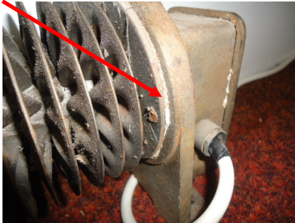
Afbeelding 13: Binnenzijde manege/Pakkingringen inclusief in oude elektrakachel
