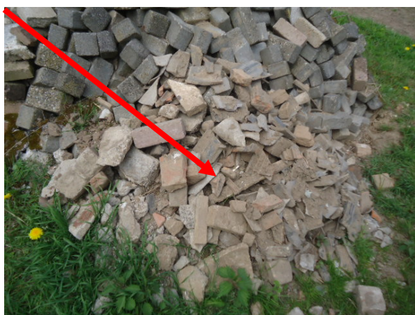
Afbeelding 21: Berg puin/Restanten asbestcement
