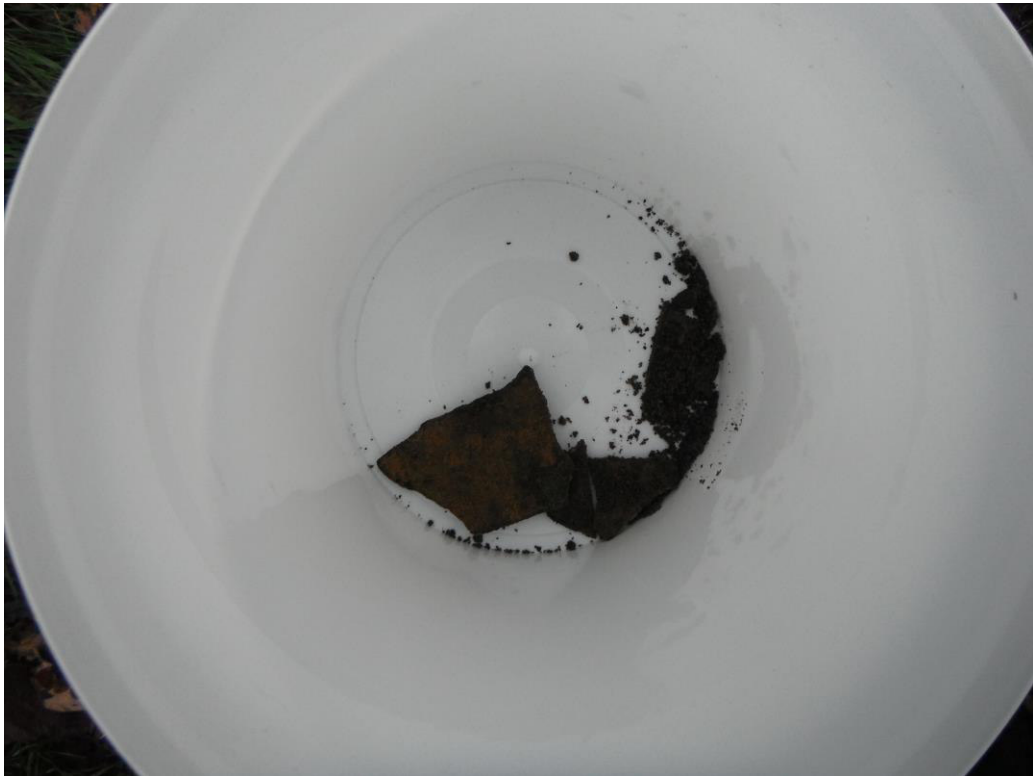
Asbestverdacht materiaal, sleuf 2
