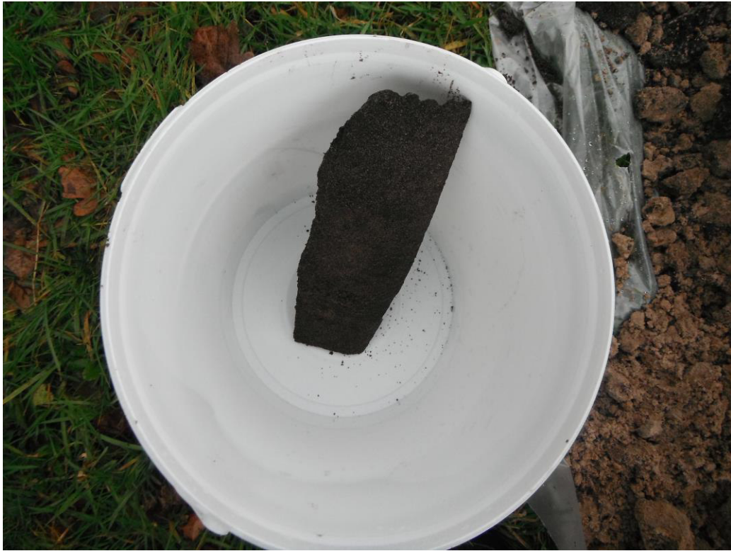
Asbestverdachte materiaal, sleuf 4
