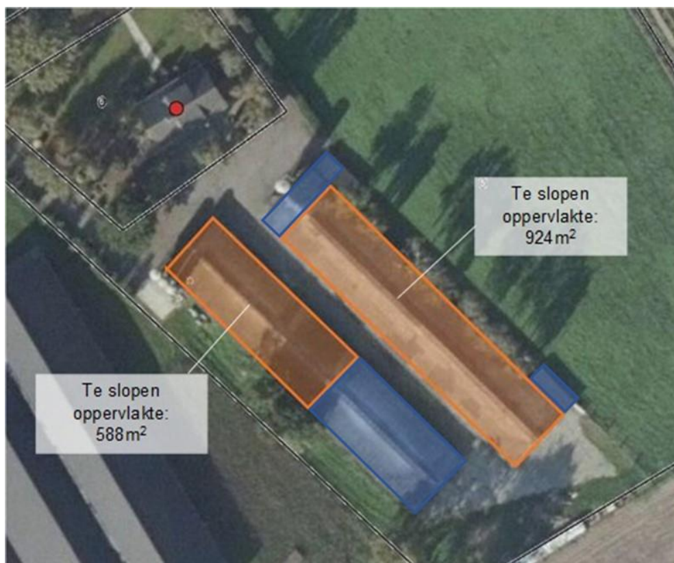
Figuur 7. Planlocatie met te slopen bebouwing oranje gearceerd.
