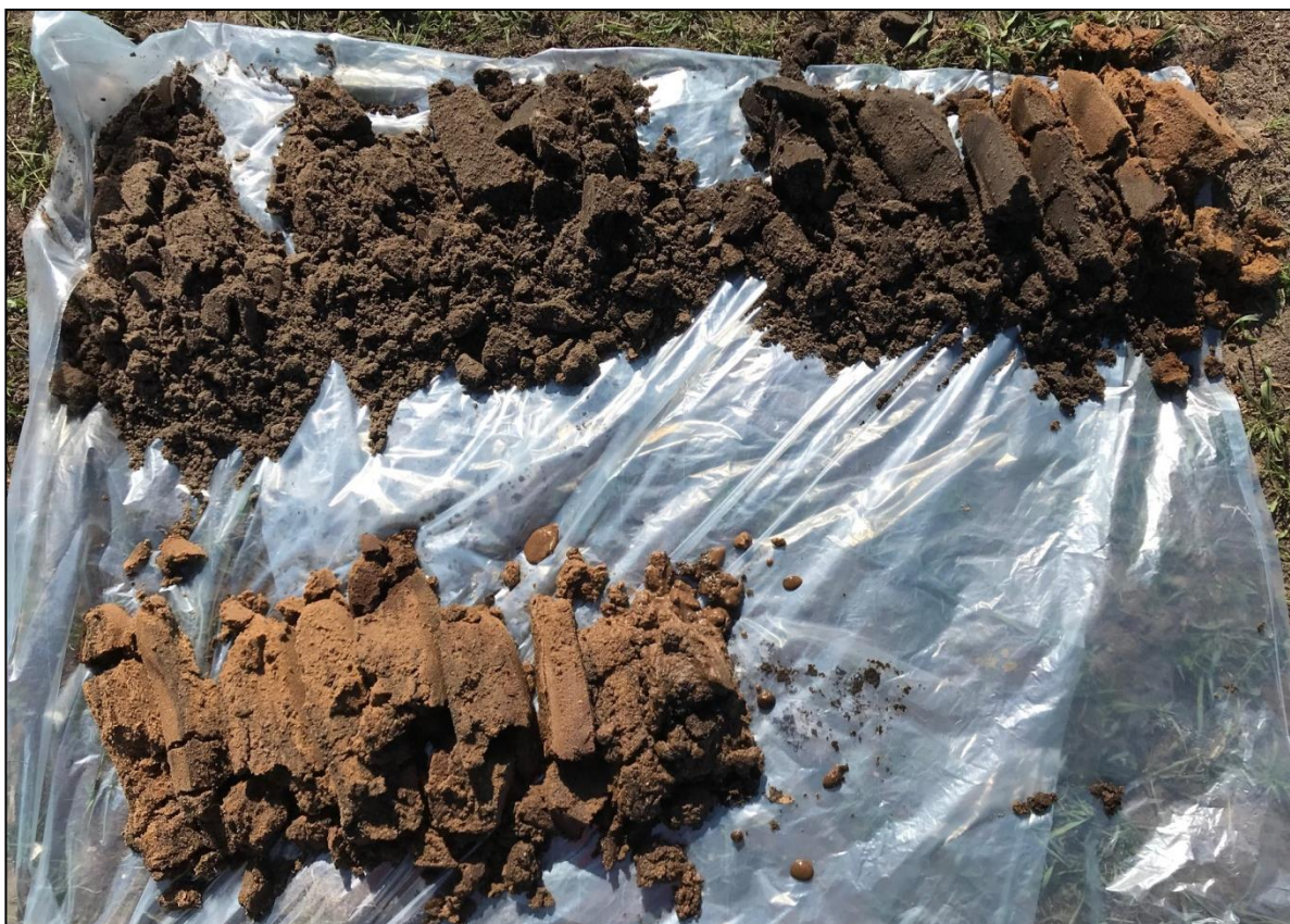
Figuur 9. Het boorprofiel van boring 5. De leesrichting is van linksboven naar rechtsonder.
