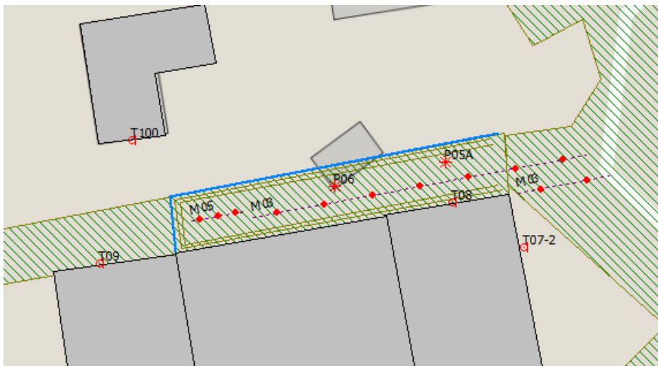
Figuur 5.2: schematische weergave laadstation noordgevel supermarkt met verdiepte liggen en afscherming.
