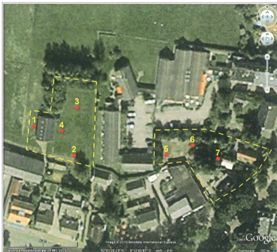
Figuur 5: Vledder, Brink: Boorpuntenkaart. Het onderzochte gebied wordt aangeduid door de onderbroken gele lijn. De genummerde punten geven de ligging van de zeven boringen aan.
