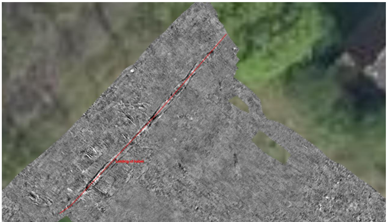
Figuur 4 Aangetroffen leiding (rood aangegeven).
