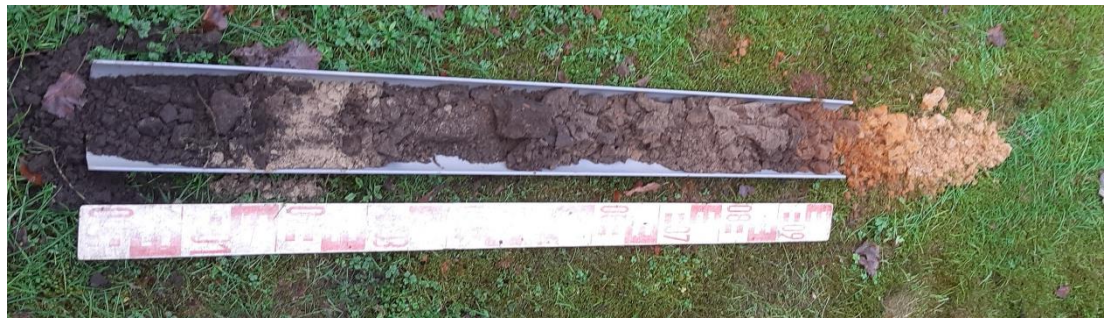
Afbeelding 16: Bodemprofiel van boring 6 met v.l.n.r. tot 1 m-mv diverse gevlekte ophogingslagen met bouwpuin (Ap1-4) en daaronder het lichtgele fijne dekzand (C-horizont) met in de top veel roestbrokjes.
