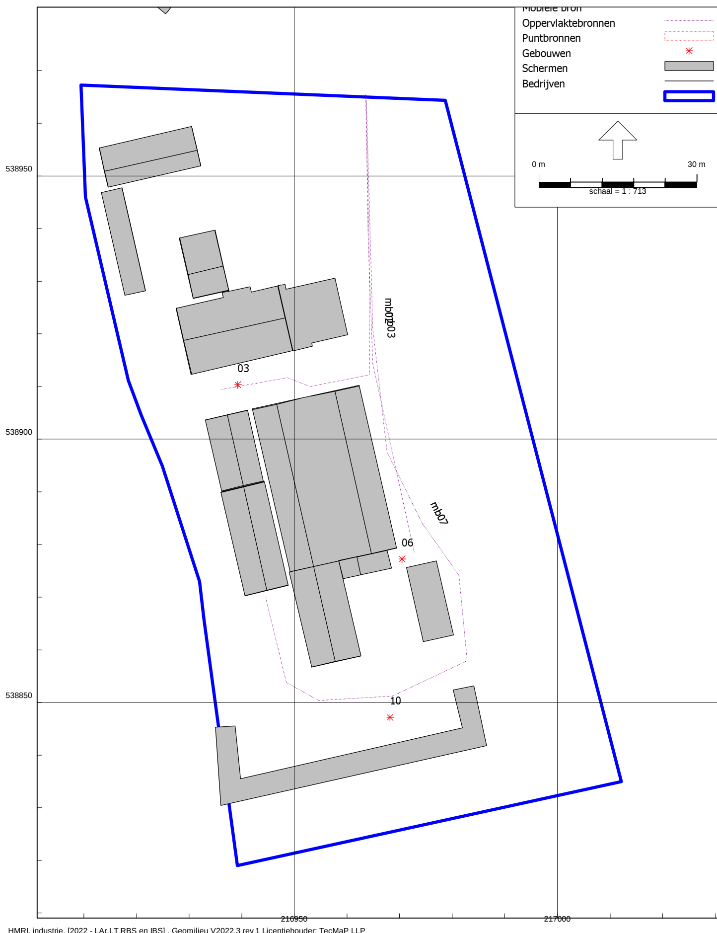
figuur 5d: Overzicht rekenmodel met locatie geluidbronnen
