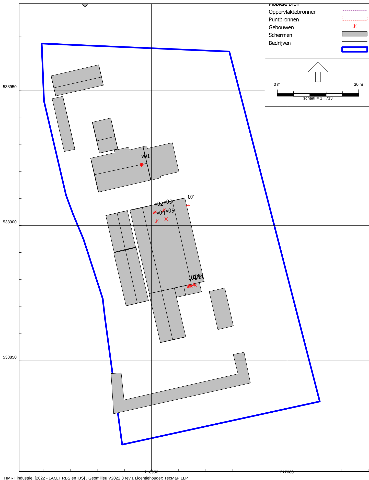
figuur 5a: Overzicht rekenmodel met locatie geluidbronnen vast opgesteld
