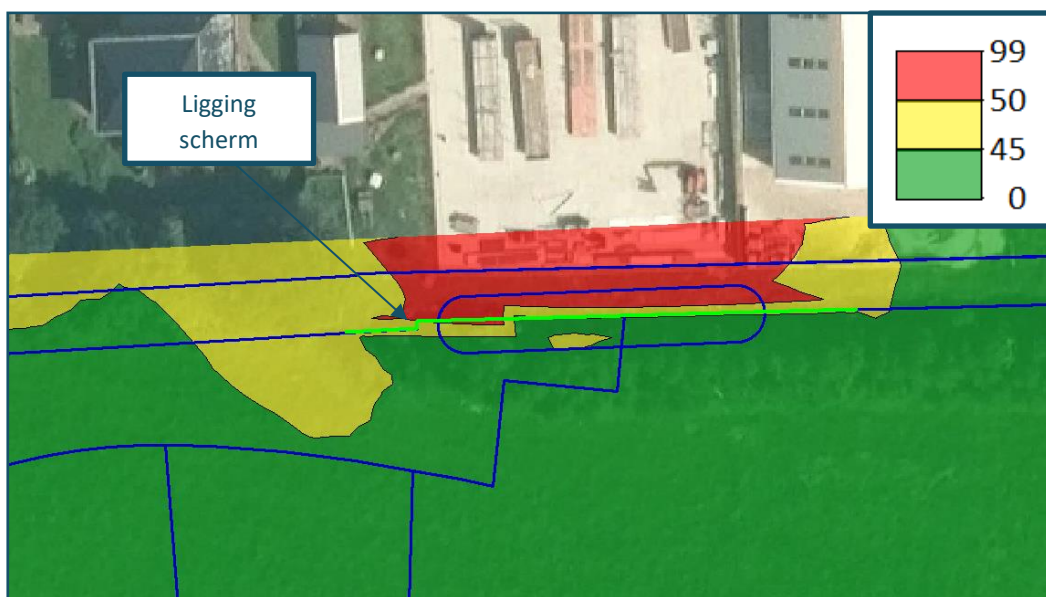
Figuur 11 Het geluid in de tuinen van de woningen na realiseren afscherming van 2,0 meter
