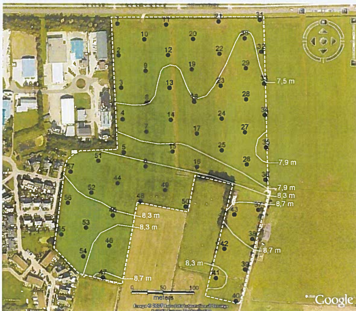
Figuur 6: Dwingeloo: Oostrand, boorpuntenkaart. Op de luchtfoto is het onderzoeksgebied weergegeven met een onderbroken witte lijn. De genummerde punten geven de ligging van de boringen weer. De witte lijnen zijn hoogtelijnen van het niet opgebrachte zand.
