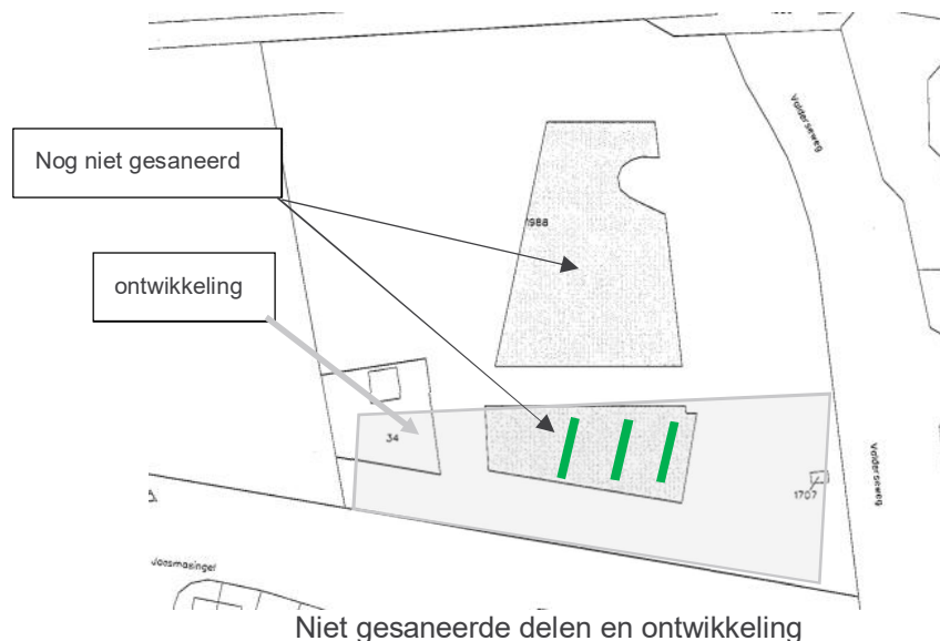
Figuur 1: situering ontgravingsvakken en niet ontgraven / gesaneerde delen voormalige stortlocatie en gewenste ontwikkeling.
