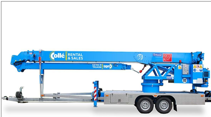
Voorbeeld van een lichte, mobiele kraan. Geschikt voor het aanreiken van o.a. dakpannen, isolatiemateriaal, glas en kozijnen.
