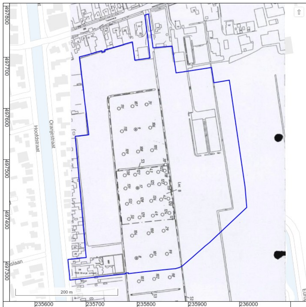
Figuur 8: Milieukundige boringen in het plangebied (Grontmij Overijssel 1996).
