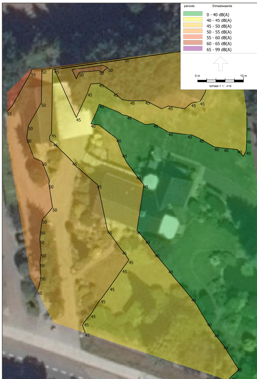
Afbeelding 3 Geluidbelasting ter plaatse van perceel Hammerweg 36 te Vroomshoop
