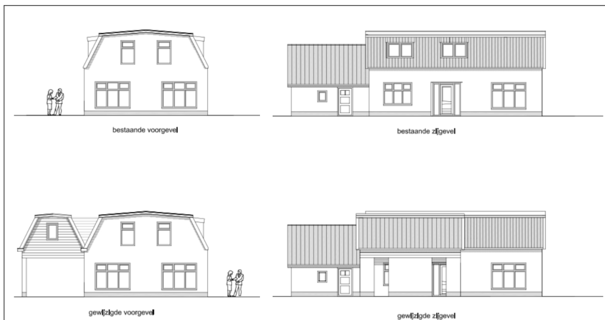
Afbeelding 3.2: Geveltekeningen bestaande woning met uitbreiding (Bron: Hofsink)
