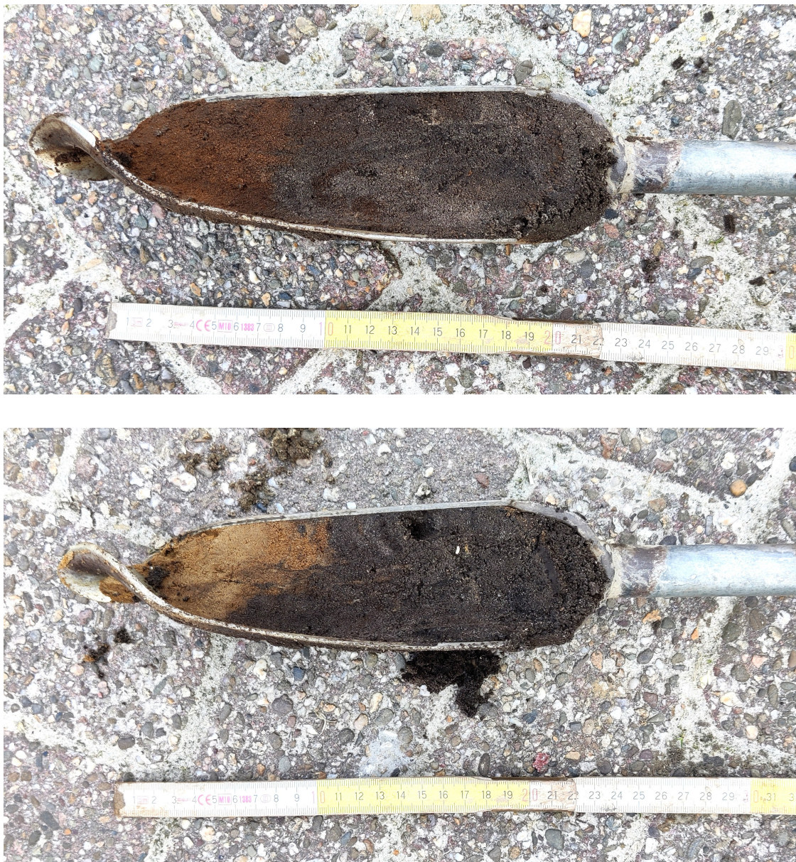
Figuur 13: Westervelde Hoofdweg 2L: Foto van de boorkoppen van boring 8A (boven) en 8B (onder). De punt van de boorkop lag beid beide boringen op 105 centimeter onder het maaiveld. Bij boring 8A (boven) was een grijze E-horizont en bruine BC-horizont aanwezig. De onderliggende C-horizont bleek vergraven te zijn (mogelijk spoor). Bij boring 8B (onder) was daarentegen direct een intacte C-horizont aanwezig.
