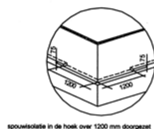
spouwisolatie in de hoek over 1200 mm doorgezet
