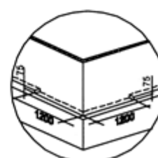
spouwisolatie in de hoek over 1200 mm doorgezet
