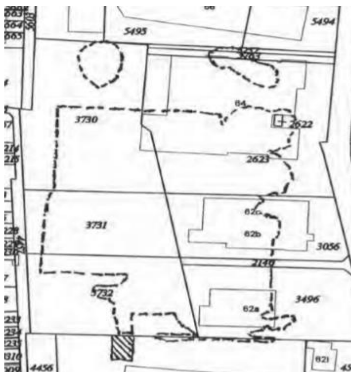
Figuur 3: overzicht gesaneerde terreindelen (onderbroken lijn) in 2006)
