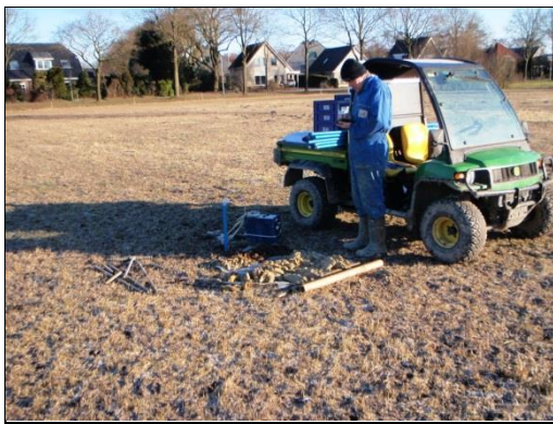
Afbeelding 14. Foto van boring 44 die milieukundig als peilbuis is uitgevoerd en tegelijk archeologisch beschreven is
