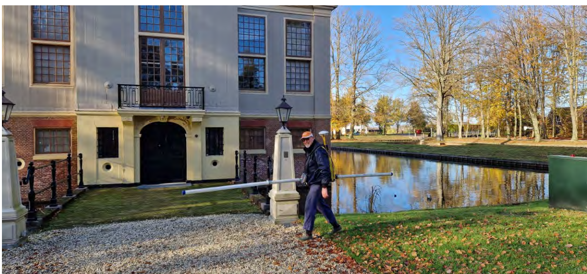
Figuur 7: Het diepe EM onderzoek in uitvoering
