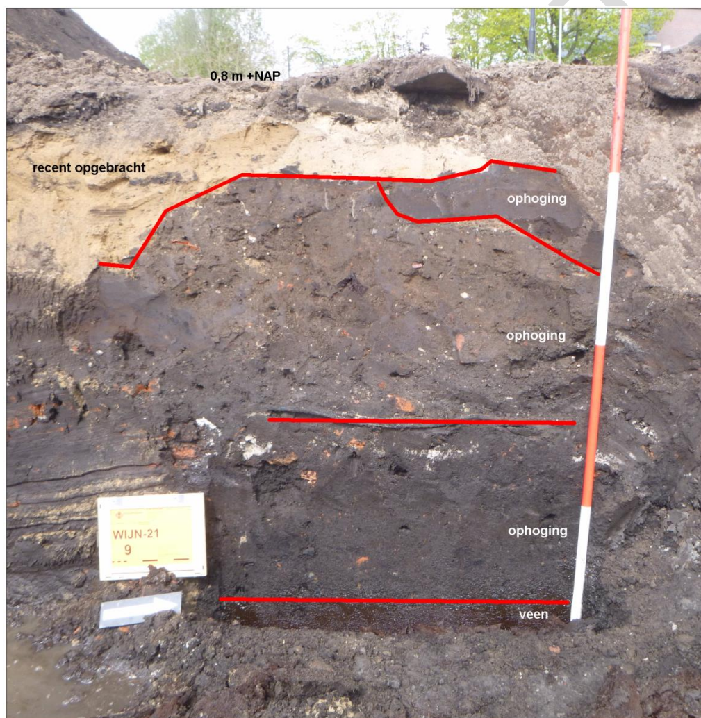
Afb. 8. Standaard bodemopbouw met veen dat wordt afgedekt door enkele kleiige ophogingslagen en een laag recent opgebracht zand.
